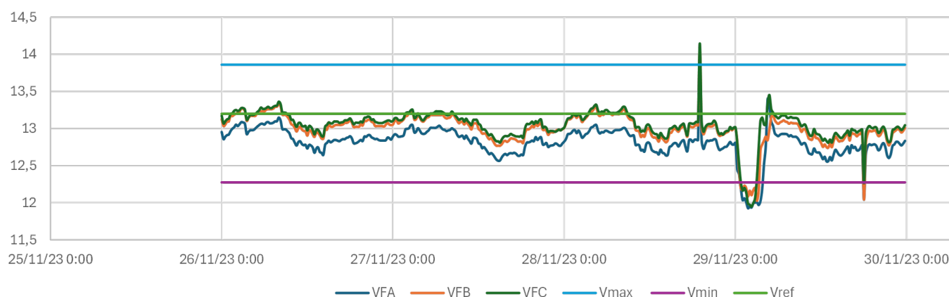
(a) Extração dos dados de tensão na religadora "R", antes da calibração do equipamento.
